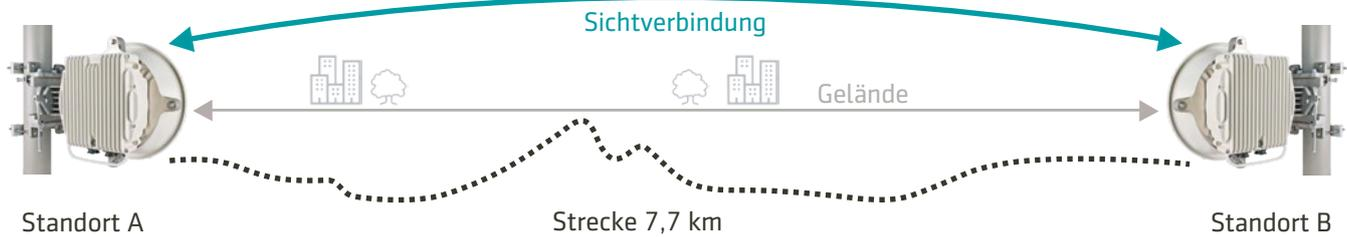
Üblicherweise werden Richtfunkssysteme als Punkt-zu-Punkt-Funksysteme ausgeführt, bei denen ein Sender Daten an einen Empfänger sendet. Generell können Richtfunkstrecken auch über Umlenkpunkte realisiert werden, sollte keine direkte Sichtverbindung bestehen.
