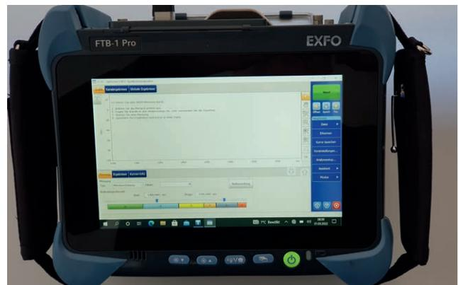
Es handelt sich um einen optischen Spektrum-Analyser (OSA), der uns in die Lage versetzt, bei Aufbau und Überprüfung von DWDM-Strecken eine Optimierung des Summensignals von Multiplexern durch Einpegelung der unterschiedlichen Kanäle vor der Zusammenführung durchzuführen.
