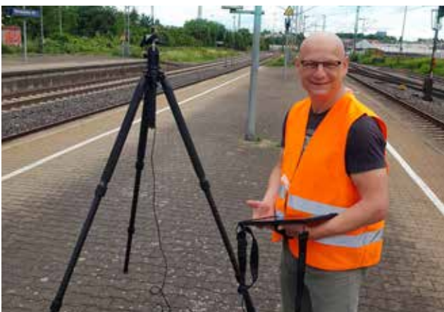
Panoramamessung mit dem Octa-Messgerät
